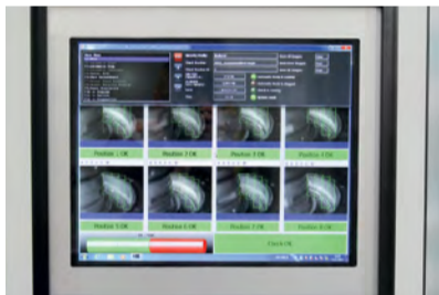
Die Information, ob die Teile in Ordnung sind oder nicht, wird auf einem Monitor ausgegeben
