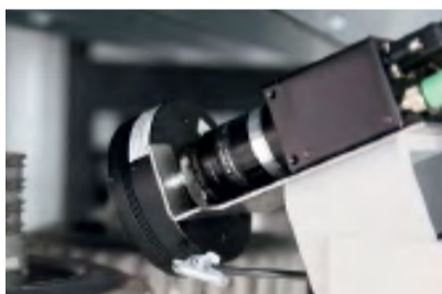
Kamera zur Kontrolle der Beschichtungsqualität
