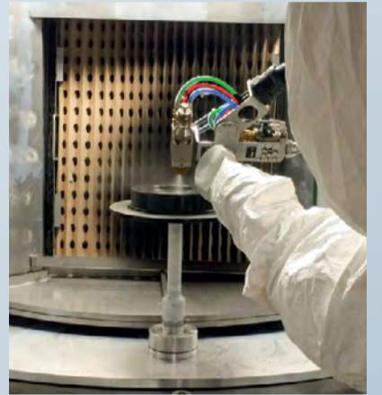
Der Beschichtroboter ist mit zwei Sprimag Spritzapparaten ausgestattet, so können unterschiedliche Schichtenanforderungen erfüllt werden
