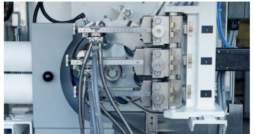
Für bestimmte Anwendungsfälle lässt sich die HIL-34 auch mit drei statt nur zwei Spritzapparaten ausstatten, dadurch kann Lack eingespart werden. Oben: Wartungsstellung, Unten: Produktionsstellung
