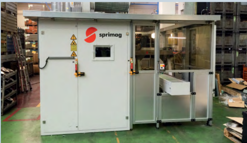
UV-Beschichtungsanlagen sind besonders kompakt, da keine Abluftstrecke und Kühlzone benötigt wird
