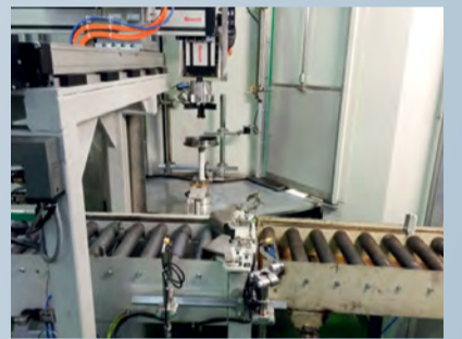
Übergabestation der Bremsscheiben mit Teileerkennung für die Produktion im Mixbetrieb
