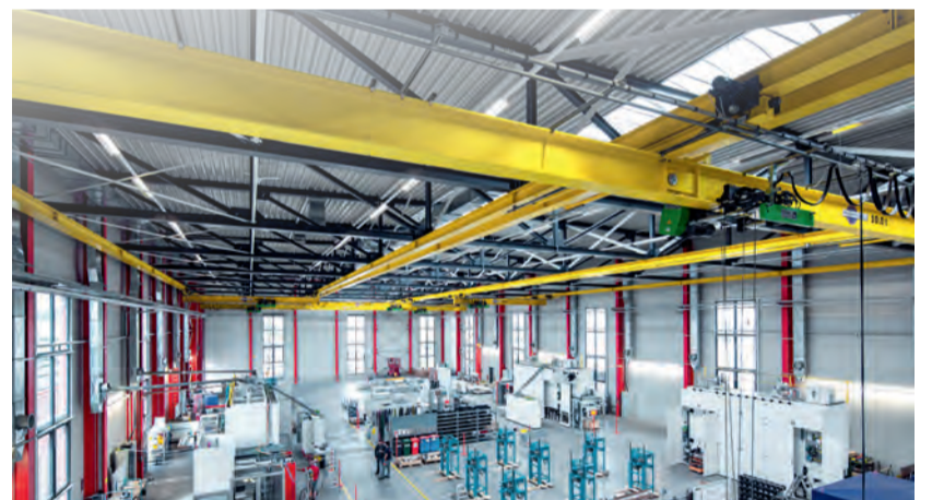
Die 2.000 m 2 große Vormontagehalle ist mit 5 Kränen ausgestattet und erlaubt somit eine flexible Endmontage-Insel
