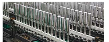
Bis zu 18.000 Teile werden pro Stunde auf der Sprimag Anlage beschichtet
