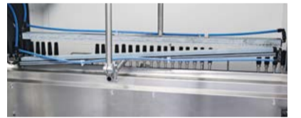
Durch die Ionisation werden die Teile entladen und bleiben so staubfrei
