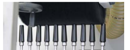
Vor der Lackierung werden die Teile in der Bürststation von Staub befreit
