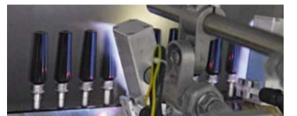
In der Befahmstation wird die Oberfläche aktiviert
